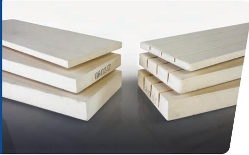
Super Caltemp® Gold 1700 en bloque es un aislamiento inorgánico, no combustible, para alta temperatura que se compone principalmente de silicato de calcio hidratado. El aislamiento se personaliza para sistemas operativos de hasta 927 °C (1700 °F). Super Caltemp Gold 1700 cumple o excede las especificaciones de propiedades físicas de la norma ASTM C533 Tipo II.
