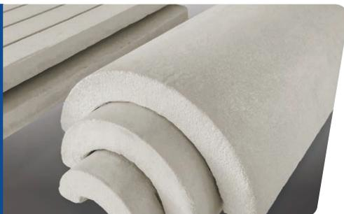
Sproule WR-1200 es un aislamiento para tubería y bloques preformado, de alta temperatura, hidrofóbico, sin efecto de mecha, compuesto de perlita expandida reforzada de manera uniforme con una fibra de alta resistencia. El XOX Corrosion Inhibitor® es integral para Sproule-1200, una fórmula y proceso distintivos que inhiben activamente la corrosión hacia las superficies externas de la tubería y los equipos.
