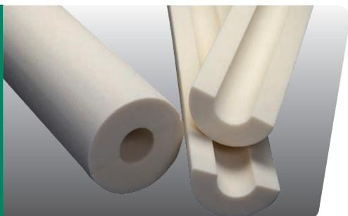
El aislamiento Trymer® 25-50 PIR es una espuma PIR de celdas cerradas diseñada para usarse en aplicaciones comerciales con agua enfriada. A diferencia de otro material PIR, el Trymer 25-50 PIR cumple con las clasificaciones de características de combustión de la superficie ASTM E84 de ≤25 dispersión de llamas y ≤50 desarrollo de humo para aplicaciones comerciales\*. Trymer 25-50 es ideal para uso en aplicaciones donde la inflamabilidad es la mayor preocupación.
