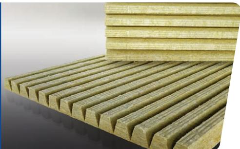
El aislamiento de tuberías con corte de precisión (PC) MinWool-1200® es un panel de lana mineral con ranurado en V de fábrica, hidrófugo que se fabrica a los tamaños específicos de la tubería o recipiente. Se ofrece con una variedad de revestimiento y se envía plano en plástico de 0,1 mm (4 milésimas de pulg.), permitiendo un formado sencillo en el sitio de trabajo.
