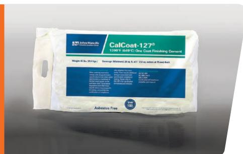
CalCoat-127® es una mezcla patentada de cemento hidráulico, silicato de calcio y fibras de mineral inorgánicas con inhibidores de corrosión que proporcionan un acabado liso sobre el aislamiento para altas temperaturas. CalCoat-127 se recomienda para el acabado con aislamiento de silicato de calcio o perlita en aplicaciones de equipo y tubería para alta temperatura.
