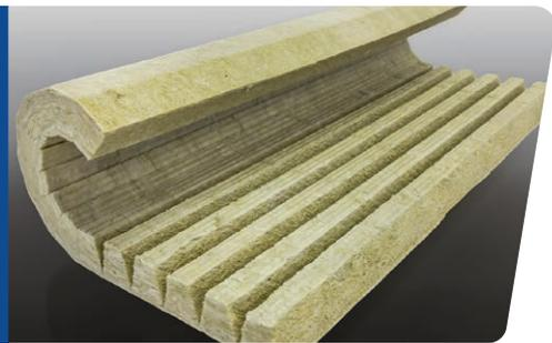
El aislamiento de tuberías formado en terreno MinWool-1200® es un panel de lana mineral con ranurado en v de fábrica, hidrófugo con adhesivos de contacto únicos en las ranuras. Se fabrica al tamaño específico de la tubería con una variedad de opciones de revestimiento. El MinWool-1200 para tubería formada en terreno se envía plano y permite un formado fácil en el sitio del trabajo.
