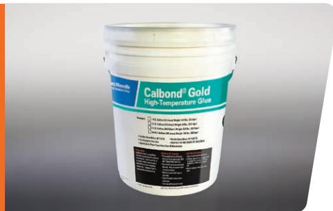
CalBond® Gold es un pegamento en base a silicato, modificado para aislamiento térmico. Se seca rápidamente para proporcionar una fijación a alta temperatura para materiales aislantes porosos. CalBond Gold es útil para fijar secciones de silicato de calcio o tubo perlita para alta temperatura o aislamiento de bloques, y hacer codos angulares, secciones de aislamiento grandes u otras formas especiales.
