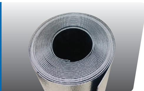
El revestimiento de barrera contra el sonido de JM 1 lb Muffl-Jac® es una película de compuesto de alta densidad laminado con 0,5 mm (0,020 pulg.) de aluminio que usa un adhesivo en película viscoelástica. Absorbe, amortigua, bloquea y aísla simultáneamente el sonido además de reducir los niveles de ruido que irradian por la tubería y equipo.
