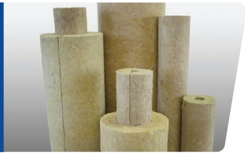
MinWool-1200® es un aislamiento de tubería hidrófugo compuesta de fibras inorgánicas derivadas del basalto, una roca volcánica. Está fabricada con un aglutinante de resina termoestable. La tecnología de fabricación avanzada garantiza una calidad de producto congruente, con fibras de alta densidad y bajo contenido de granalla, para un desempeño excelente en aplicaciones de control térmico a altas temperaturas y de resistencia al fuego.
